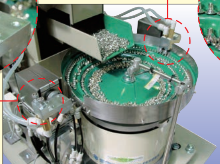
皿ビス用エスケープ付パーツフィーダシステム Parts feeder system w/escape for countersunk head screws
